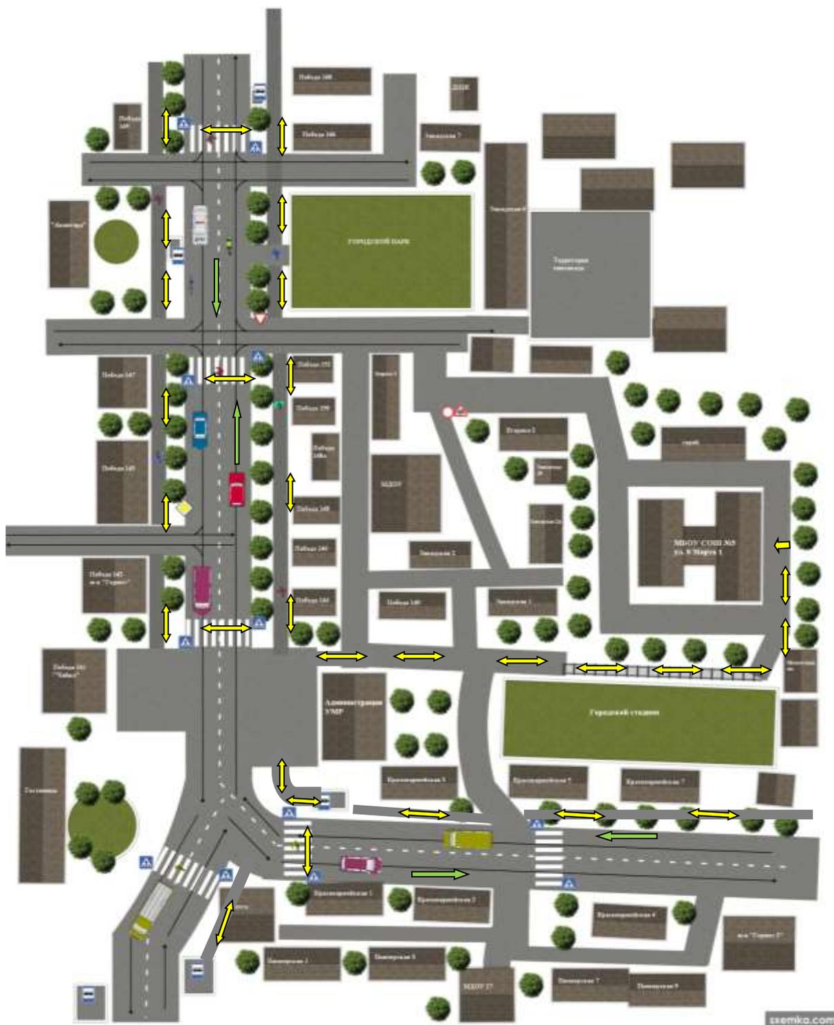
**II. Схема организации дорожного движения в непосредственной близости от МБОУ СОШ №5 г. Угледорска с размещением соответствующих технических средств, маршруты движения детей и расположение парковочных мест**
