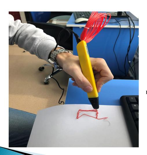
3D-ручка — инструмент для рисования пластиком, позволяющий создавать трёхмерные объекты. Используется для творчества, развивающих занятий с детьми, коррекции изделий, напечатанных с помощью 3D-принтера, и мелкого бытового ремонта пластиковых предметов
