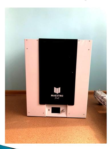
3D-принтер — внешнее устройство компьютера, которое является нечем иным, как станком с числовым программным управлением (ЧПУ) предназначенным для быстрого получения прототипов изделий, спроектированных на ПК, методом послойной печати.
